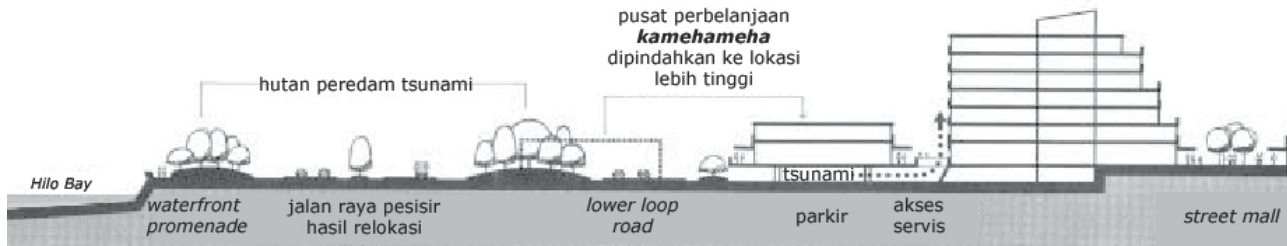
Gambar potongan tapak, bagian dari rencana pembangunan pusat kota Hilo
