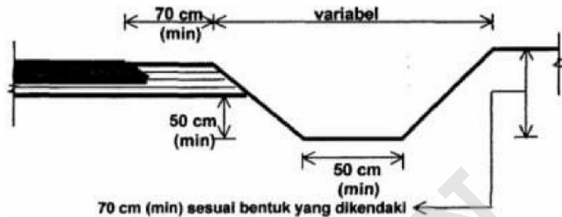
Gambar 7-13 Penampang Melintang Saluran Samping Jalan
